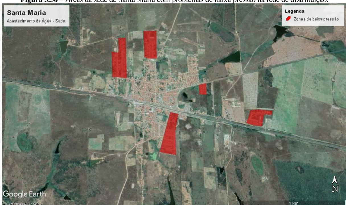
Figura 3.36 – Áreas da sede de Santa Maria com problemas de baixa pressão na rede de distribuição.
