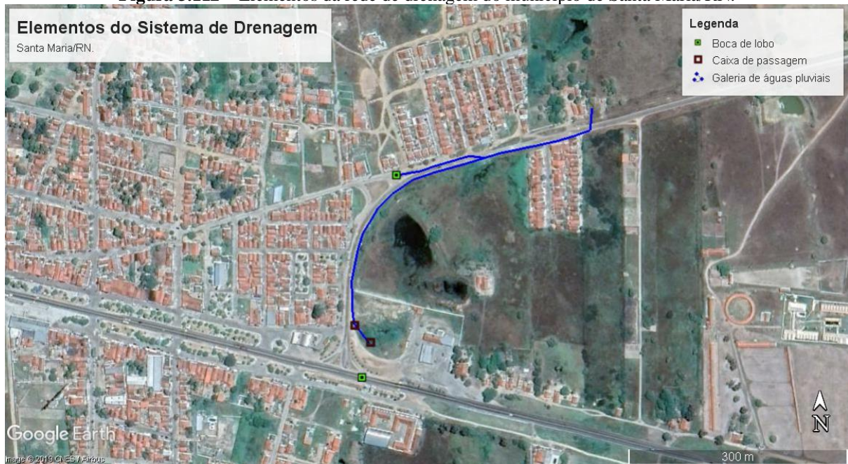
Figura 3.112 – Elementos da rede de drenagem do município de Santa Maria/RN.
